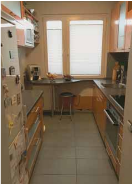
Rycina 7.1. Kuchnia otwarta, o małej powierzchni, wąska, bez pola manewrowego dla wózka.
